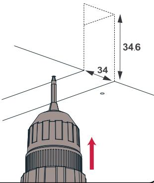
**4** Instale los chazos (dependiendo el material del techo) en los orificios previamente realizados.
