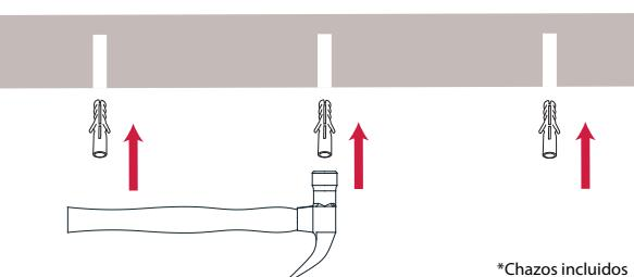
Incruste el perfil en el techo y/o pared, luego asegurelo con sus respectivos tornillos (se recomienda utilizar tornillos color negro) como se muestra en la siguiente imagen. Para perfiles de dos (2) metros use minimo tres (3) tornillos por cada lado del perfil para asegurarlo al techo
